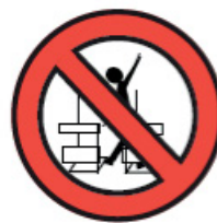
PROHIBIDO EL USO ANDAMIO INCOMPLETO
